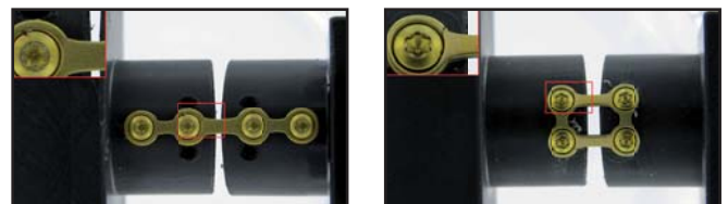
Abbildung 8 Platten ohne Verblockung nach den Tests. Links: A-4300.01 (geknickt), rechts: 4300.51 (gebrochen)
